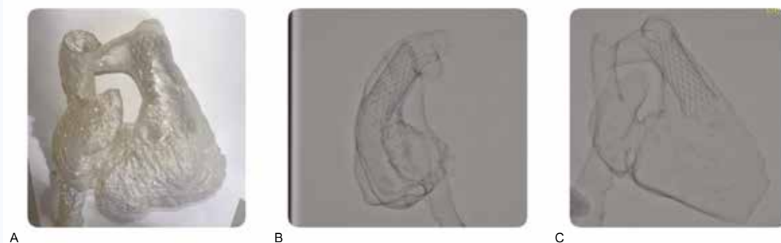
Рис. 4. Имплантация каркаса клапана in vitro в силиконовую 3D модель сердца пациента. А – общий вид протеза в модели, В – рентгенограмма, вид сбоку, С – рентгенограмма, вид в прямой проекции Fig. 4. Implantation of a valve frame in vitro into a silicone 3D model of the patient's heart. A – general view of the prosthesis in the model, B – side view of the radiograph, C – frontal view of the radiograph
