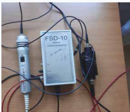
Рис. 1. Вид установки для люминесцентной спектроскопии (А – общий вид, Б – (слева направо) эксимерный лазер, спектрометр, фильтр для очистки сигнала)
