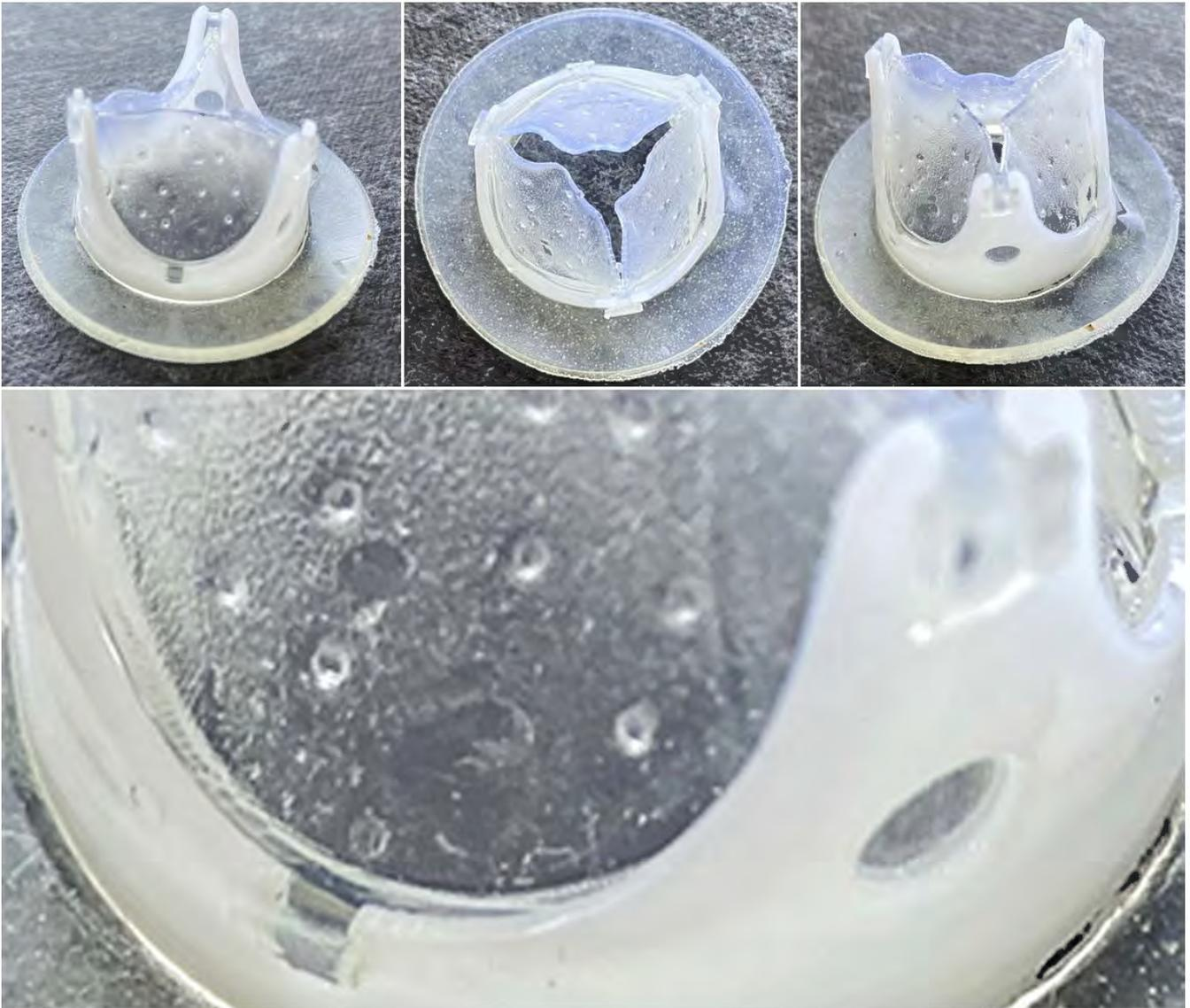
Рисунок 5. Фотографии прототипа протеза, напечатанного на 3D-принтере, укрупненный вид демонстрирует наличие дефектов от поддержек на створчатом аппарате
