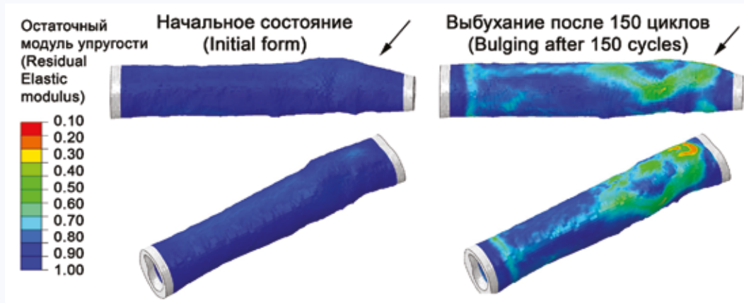
Рис. 4. Эпюры численного моделирования, визуализирующие степень деградации модуля упругости материала сосуда, в результате воздействия циклической нагрузки (условных 150 циклов приложения давления): начальное и итоговое состояние после моделирования
